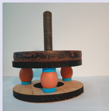
图 1-15 鸡蛋受力试验
