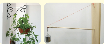
图 1-10 吊兰盆栽支撑架与结构模型
